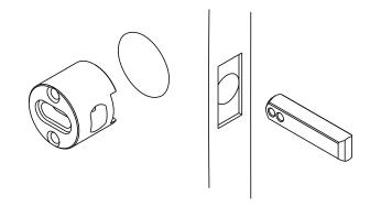
INTERIOR SIDE: INSERT CARRIER AS SHOWN.
